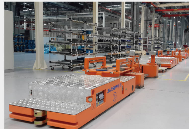
爱科（常州）农业机械有限公司现场 Inductive Power Transfer AGVs applied in AGCO(Changzhou)
