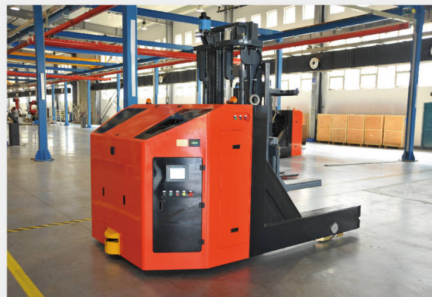
应用于大西洋焊丝项目 AGVs for Atlantic China Welding Consumables, Inc.
